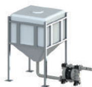
Bomba instalada en la tolva para líquidos de alta viscosidad
