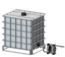
Bomba instalada debajo de la cabeza (aspiración positiva)
