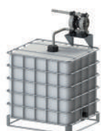
Bomba autocebante instalada sobre el cabezal (aspiración negativa)
