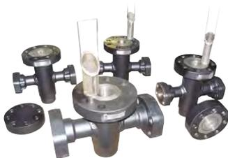
Filtros de cesta simplex de alta presión diseñados para un sistema de agua hidráulica de 400 bar. Se usa para proteger las válvulas servo en una prensa de forjado.
