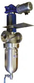
Filtración auto limpiante totalmente automática de resina y pinturas de alta temperatura en España e Italia. Automatización adaptada a un servicio hostil de alta temperatura, accionamientos especiales, válvulas y DP
